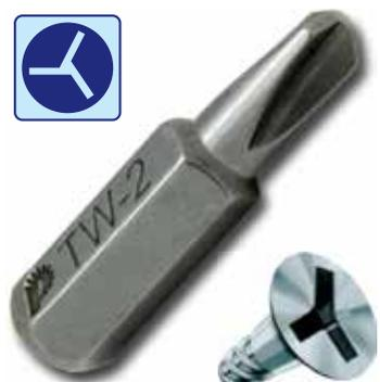
Отверточные насадки ПРАКТИКА серии «Профи» предназначены для профессионального использования. Изготовлены из легированной хромванадиевой стали (CrV-S2) с поверхностным упрочнением до твердости 58-59 HRC токами высокой частоты (ТВЧ). Имеют проточенную головную часть для работы в узких местах. Точная форма рабочей части обеспечивает идеальную фиксацию в шлицах самореза. Боковая поверхность отполирована. Магнитные свойства позволяют удерживать саморез в любом удобном положении.
