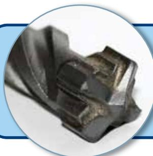
Цельная X-образная твердосплавная напайка обеспечивает прекрасную производительность работы в сочетании с высоким ресурсом. X-образная форма образует 4 отдельные спирали для наилучшего вывода шлама из отверстия.
