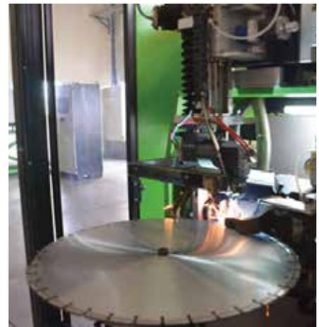
Лазерная сварка или припаивание
