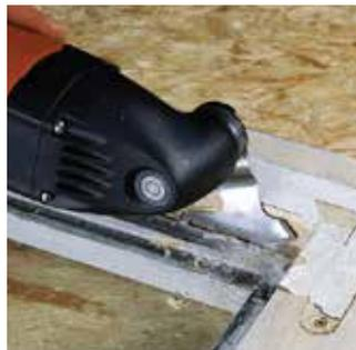
Насадка режущая предназначена для обработки дерева, фанеры, пластиков, мягких металлов, комбинаций материалов с помощью многофункционального инструмента (МФИ).
