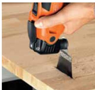
Насадка режущая предназначена для обработки дерева, фанеры, пластика, листов ГКЛ с помощью многофункционального инструмента (МФИ).
