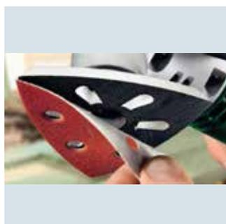
Листы шлифовальные абразивные с 6-ю отверстиями для пылеудаления предназначены для обработки дерева, металла, удаления лакокрасочных покрытий и ржавчины с помощью многофункционального инструмента (МФИ) или дельтавидной шлифмашины.
