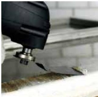
Насадка шабер предназначена для очистки поверхности от клея, штукатурки, краски, шпатлевки, герметика и других пластичных материалов с помощью многофункционального инструмента (МФИ).
