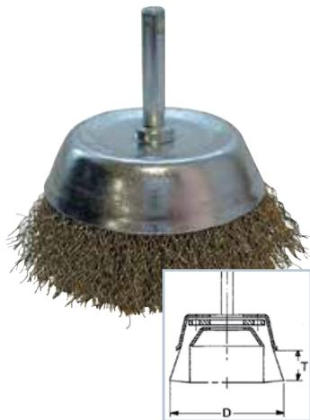
Кордщетка для дрели. Хвостовик 6 мм для закрепления в патроне. Гофрированная стальная проволока. Для обработки деревянных и металлических поверхностей, снятия краски, ржавчины.
