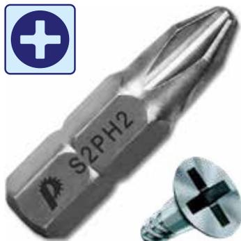
Отверточные насадки ПРАКТИКА серии «Мастер» при невысокой стоимости обладают хорошими рабочими характеристиками для большинства работ, где не требуется высокая интенсивность. Имеют простую шестигранную форму. Изготовлены из легированной инструментальной стали S2 твердостью 56-57 HRC. Магнитные свойства позволяют удерживать саморез в любом удобном положении.
