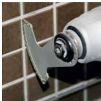
Набор насадок режущих предназначен для обработки дерева, ДСП, фанеры, пластика, листов ГКЛ, стали, цветных металлов, плитки, камня с помощью многофункционального инструмента (МФИ).
