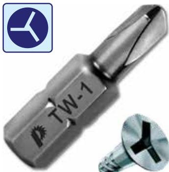
Отверточные насадки ПРАКТИКА серии «Профи» предназначены для профессионального использования. Изготовлены из комплексно легированной стали S2 методомковки с поверхностным упрочнением до твердости 58-59 HRC токами высокой частоты (ТВЧ). Имеют проточенную головную часть для работы в узких местах. Точная форма рабочей части обеспечивает идеальную фиксацию в шлицах самореза. Боковая поверхность отполирована. Магнитные свойства позволяют удерживать саморез в любом удобном положении.
