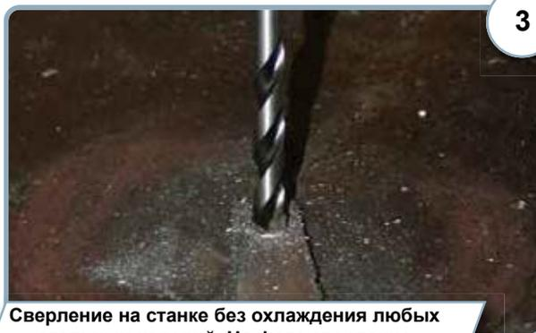
Сверление на станке без охлаждения любых стальных изделий. На фото сверление напильника твердостью 65HRC.
