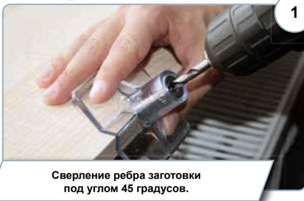
Сверление ребра заготовки под углом 45 градусов.
