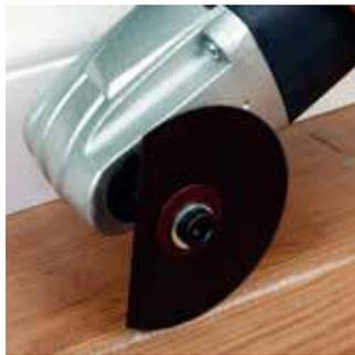
Набор насадок режущих предназначен для обработки дерева, фанеры, пластика, листов ГКЛ с помощью многофункционального инструмента (МФИ).
