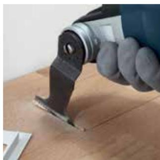
Насадка режущая пазовая 44мм предназначена для обработки дерева, фанеры, пластика, листов ГКЛ с помощью многофункционального инструмента (МФИ).
