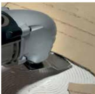
Насадка шабер предназначена для обработки поверхности под склейку и окраску с помощью многофункционального инструмента (МФИ).
