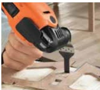
Насадка режущая предназначена для обработки дерева, фанеры, пластика, листов ГКЛ с помощью многофункционального инструмента (МФИ).
