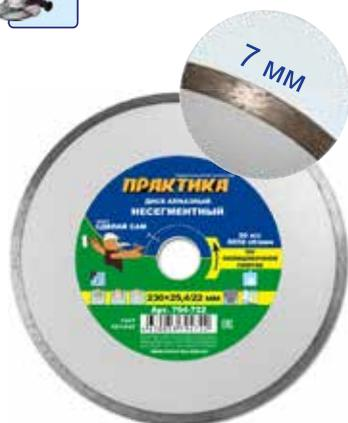
Для резки кафеля, керамической и мраморной плитки. Охлаждение водой. Чистые кромки без сколов. Не подходит для керамогранита.
