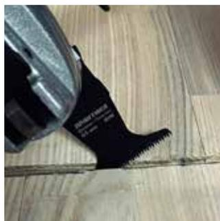
Насадка режущая предназначена для обработки твердого дерева, ДСП, ЛДСП, OSB, пластиков с помощью многофункционального инструмента (МФИ). Наиболее удобна для выполнения таких работ как: отрезание пластиковых труб и профилей, прямолинейное резание ДСП и фанеры, обрезка нагелей заподлицо с поверхностью, подрезание облицовки стен и наличников заподлицо при укладке паркетной доски, вырезание больших проемов в листовых материалах под провода, трубы, люки. Обеспечивает высокую скорость реза.
