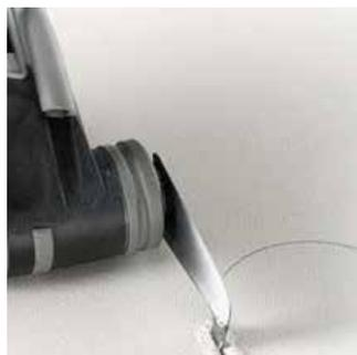
Насадка режущая предназначена для фигурной обработки листов ГКЛ, фанеры, пластика и других тонколистовых материалов с помощью многофункционального инструмента (МФИ).
