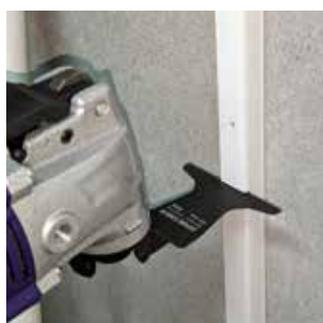
Насадка режущая прямая 68мм предназначена для обработки стали, цветных металлов, дерева, ДСП, пластиков с помощью многофункционального инструмента (МФИ).
