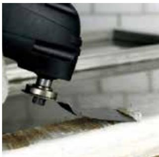
Насадка шабер предназначена для очистки поверхности от клея, штукатурки, краски, шпатлевки, герметики и других пластичных материалов с помощью многофункционального инструмента (МФИ).
