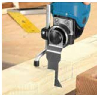
Насадка режущая предназначена для обработки дерева, фанеры, пластика, листов ГКЛ с помощью многофункционального инструмента (МФИ).
