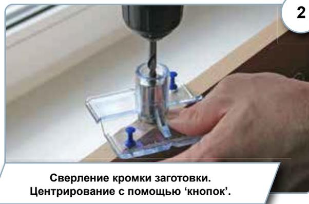
Сверление кромки заготовки. Центрирование с помощью 'кнопок'.
