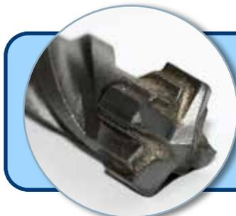
Цельная X-образная твердосплавная напайка обеспечивает прекрасную производительность работы в сочетании с высоким ресурсом. X-образная форма образует 4 отдельные спирали для наилучшего вывода шлама из отверстия.
