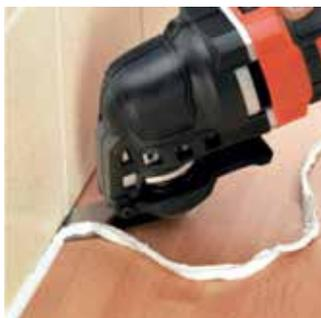
Насадка режущая предназначена для обработки мягких рулонных и листовых материалов с помощью многофункционального инструмента (МФИ). Насадка наиболее удобна для выполнения таких работ как: резка пенопласта, минеральной ваты, картона, напольных покрытий, кожи, резины, расшивка швов, удаление герметика, изоляционных материалов и уплотнений в окнах.
