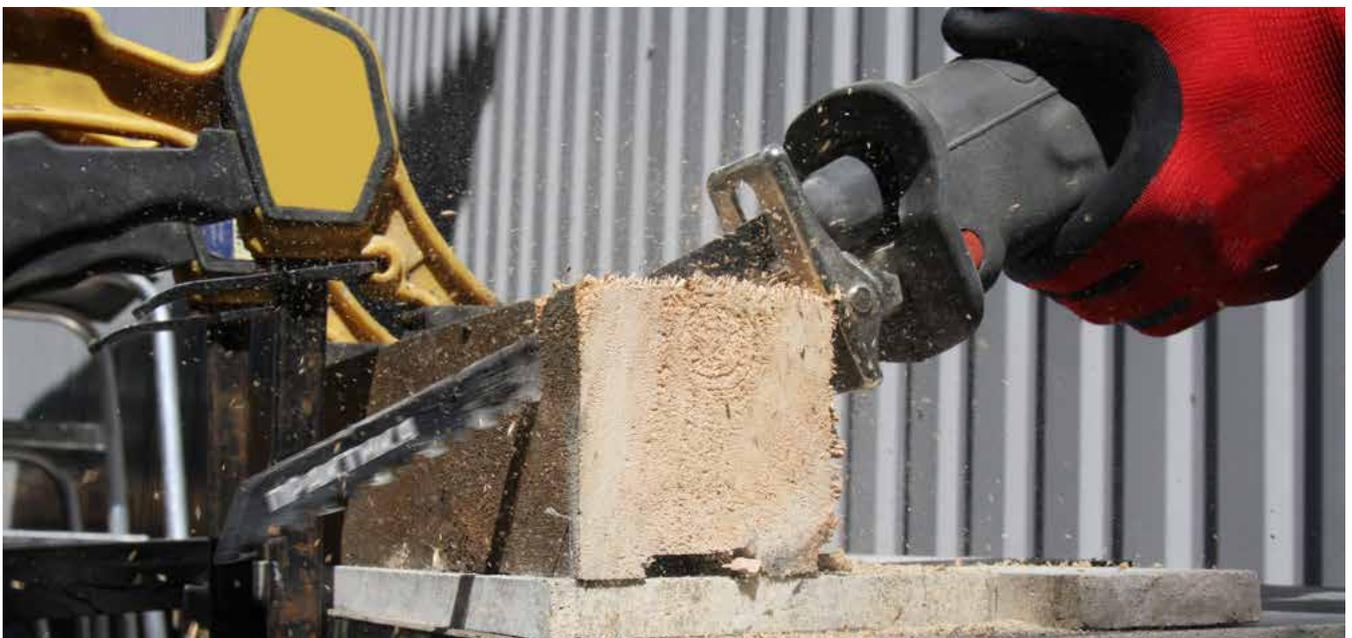
**ПРАКТИКА** Пилки с твердосплавными напайками (ТСТ)
