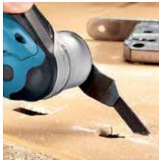
Насадка режущая пазовая 10мм предназначена для обработки стали, цветных металлов, дерева, ДСП, пластиков с помощью многофункционального инструмента (МФИ).
