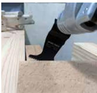
Насадка режущая предназначена для обработки дерева, фанеры, пластика, листов ГКЛ с помощью многофункционального инструмента (МФИ). Насадка наиболее удобна для выполнения таких работ как: прямолинейное резание доски и фанеры, подрезание облицовки стен и наличников заподлицо при укладке паркетной доски, вырезание больших проемов в листовых материалах под провода, трубы, люки. Обеспечивает высокую скорость реза. Изготовлена из высокоуглеродистой инструментальной стали.
