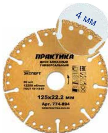
Уникальные диски с непревзойденными качествами. Пригодны для резки любых материалов от абразивных (асфальт, силикатный кирпич) до металлических профилей и дерева. Новая вентилируемая конструкция тела диска для лучшего воздушного охлаждения и предотвращения перегрева.
