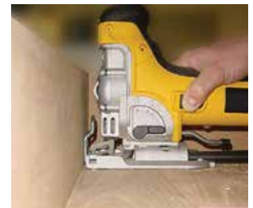
*T142NB уникальная пилка позволяющая пилить вплотную к стене.
