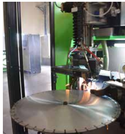
Лазерная сварка сегмента
