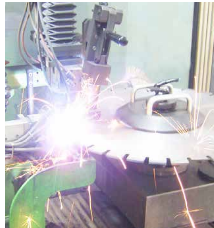
Лазерная сварка сегмента
