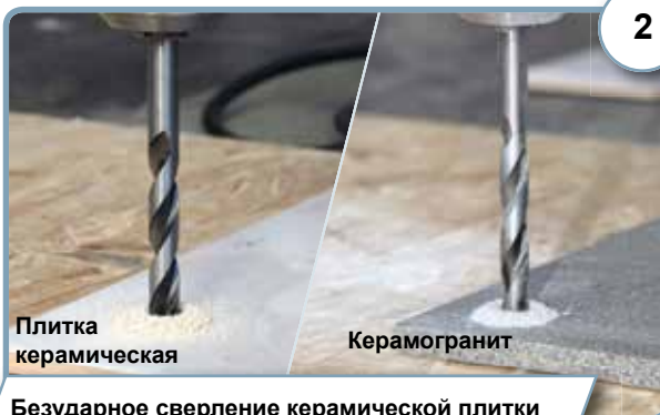
Безударное сверление керамической плитки и керамогранита.
